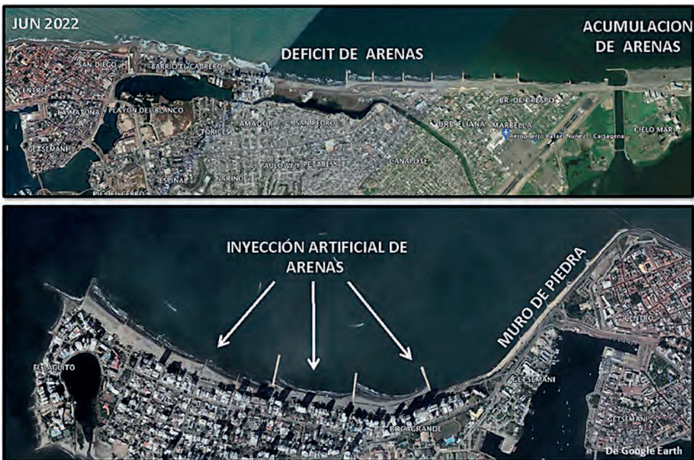
Figura 9. Línea de costa de Cartagena de Indias en junio de 2022: (A) la línea de costa muestra la acumulación de material hasta la Bocana estabilizada en la ciénaga de Tesca y los sectores erosionados hacia el oeste por la falta de arenas, llenos de varios tipos de estructuras de piedra que pretenden mitigar dicha erosión hasta el centro de la ciudad. (B) Las nuevas estructuras tendientes a estabilizar la erosión en Bocagrande demandan una importante inyección artificial de arenas debido a que el recorrido natural se encuentra suspendido por efectos de la Bocana.
